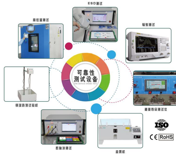
图 4-1 可靠性测试设备
